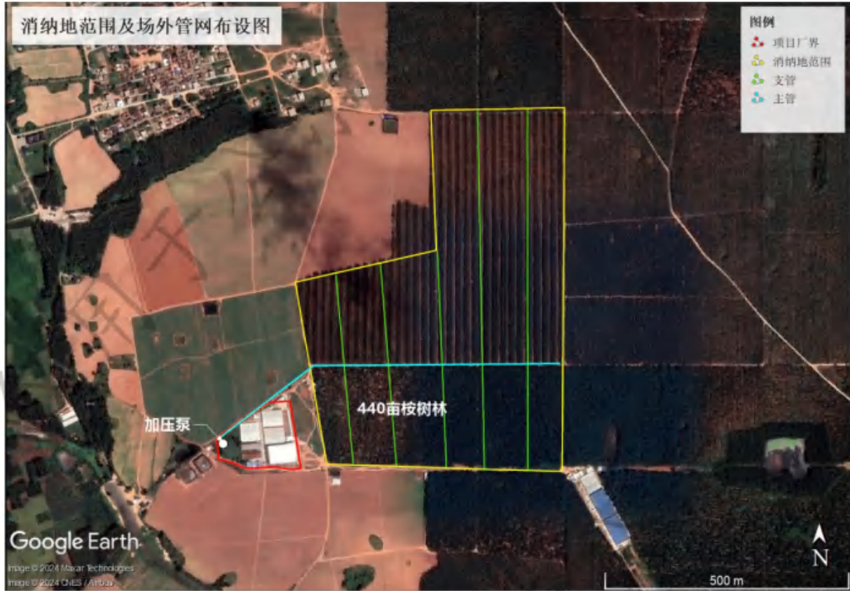
图 5.2.2-1 项目消纳地范围及场外管网布设图
